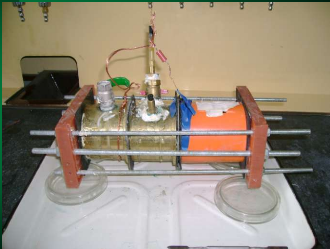
Рис.15.Лабораторные испытания электробиореактора.
